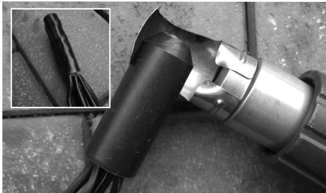
Для придания дополнительной герметичности кабельному соединению, сделанному с помощью конусной муфты, возможно использовать внешнюю термоусадочную муфту. Такая защита особенно актуально при установке светильников Beckstone под водой, например в ручьях, в каскадах или в других местах прямого контакта с водой.
